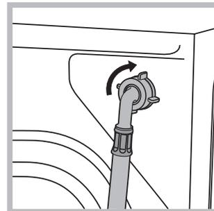
2. Anslut inloppsslangen till tvättmaskinen genom att skruva fast den till det avsedda vattenuttaget i den bakre delen uppe till höger (se figur).
