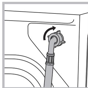
2. Skru forsynings-slangen til vaskemaskinen på vandindtaget øverst til højre bagpå (se illustrationen).
