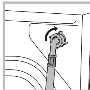
2. Kople inntaksslangen til vaskemaskinen ved å stramme den til vannuttaket opp til høyre på baksiden (se figur).
