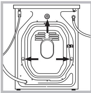
3. Ta bort de 3 skruvarna och gummidelen med dess avståndsbrixa, som sitter på bakstycket, och som skyddat maskinen under transporten (se figur).
