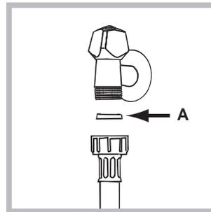
1. För in packningen A i inloppslangens ände och skruva fast den till en kallvattenkran som har en öppning med 3/4 gasgånga (se figur). Innan du ansluter slangen ska du låta vattnet rinna tills det är helt klart.
