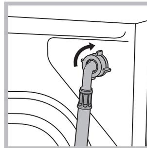
2. Conectați tubul de alimentare la mașina de spălat, înșurubându-l la respectiva priză de apă, în partea posterioară, sus în dreapta (vezi figura).
