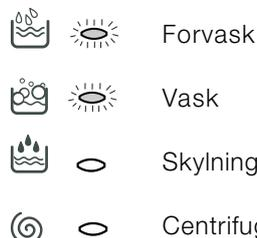
Bemærk: i tømningssfasen tændes kontrollampen for Centrifugering.
