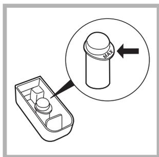
Sätt i det bifogade tilläggsfacket 4 i fack 1. Var noga när du håller i blekmedel så att du inte överstiger markeringen för "max" som anges på mitttappen (se figur).
