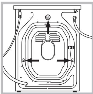
3. Fjern de 3 beskyttelsesskruene brukt for transporten og gummidelen med tilhørende avstandsstykke plassert på baksiden (se figur).
