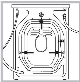
3. Poista takaosassa sijaitsevat neljä kuljetuksen suojaruuvia ja suojakumi vastaavan väläkappaleen kanssa (katso kuva).
